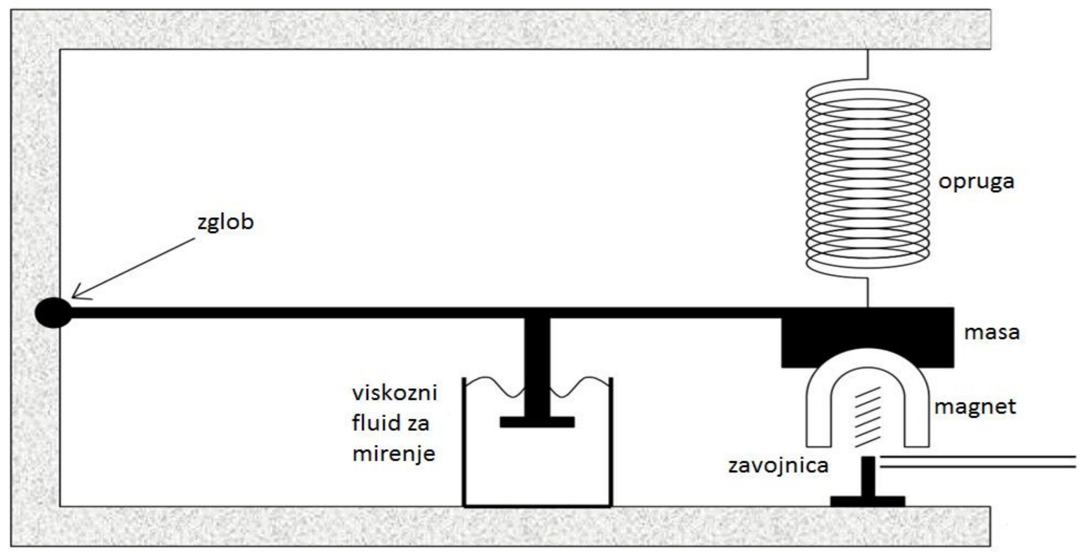
**GORE:** Vertikalni seismometar s oprugom. Mehanički mu je spriječeno gibanje u horizontalnim smjerovima te se registrira samo vertikalni pomak. Za mirenje se koristi viskozna tekućina. Pomaci se preko zavojnice u magnetnom polju prenose na spravu za registriranje.
