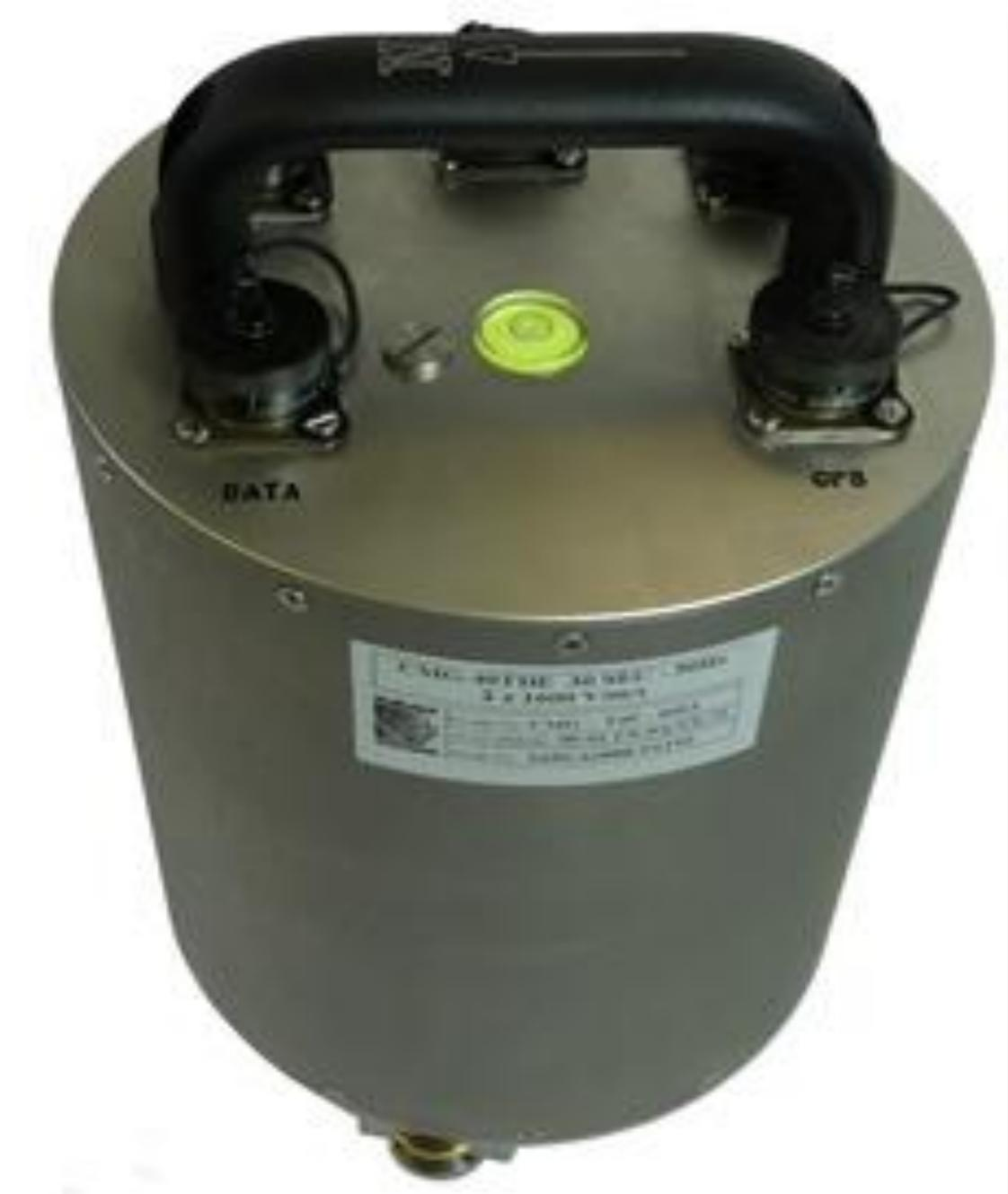
**GORE LIJEVO:** Wiechertov mehanički horizontalni seismograf iz 1909. godine, mase njihala 1000 kg (Memorijalne prostorije Andrije Mohorovičića). **GORE DESNO:** Suvremenii širokopojasni seismograf koji radi na principu elektromagnetske indukcije.
